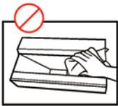
Das Objektiv darf nicht mit den Händen berührt oder mit einem Reinigungstuch abgewischt werden. Die optische Beschichtung wird sonst beschädigt, was die Bildqualität beeinträchtigt.
